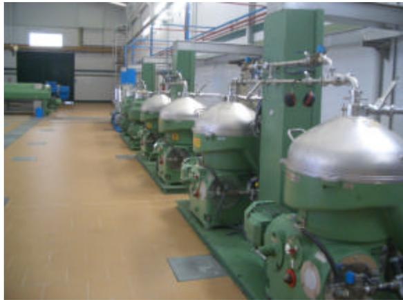
Dado que en esta parte del proceso se produce un contacto muy directo del agua caliente con el aceite, se debe controlar exhaustivamente la temperatura del agua, que en ningún caso debe superar 36° C.
