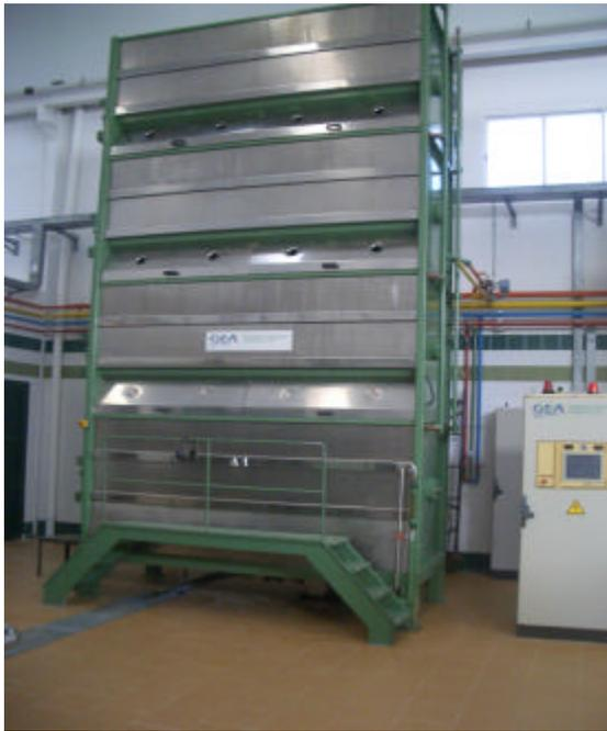
El tiempo de batido, fundamental para una adecuada separación de las fases, oscila entre una hora y media y dos horas.
