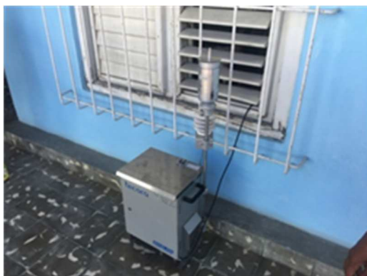
Figura 3. Captador Tecora de bajo volumen PM 10 a 38,3 L/min.
